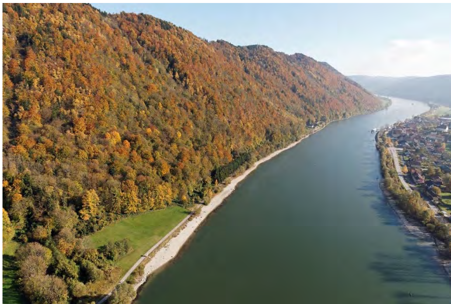
Abbildung 48: In Donauengtätern beschränkt sich die Möglichkeit für Renaturierungsmaßnahmen in der Regel auf die Schüttung von Schotterbänken. Diese bieten keinen Schutz vor schiffahrtsbedingtem Wellenschlag.
